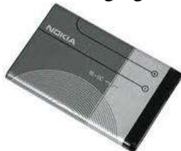
Fig. 22. Lithium – Ion Battery
